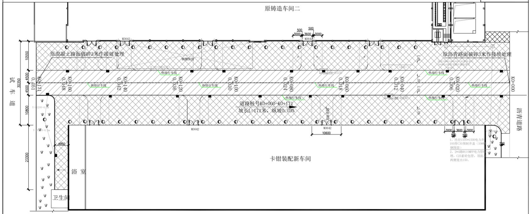
原铸造车间二^卡钳装配新车间中间道路改造平面图
